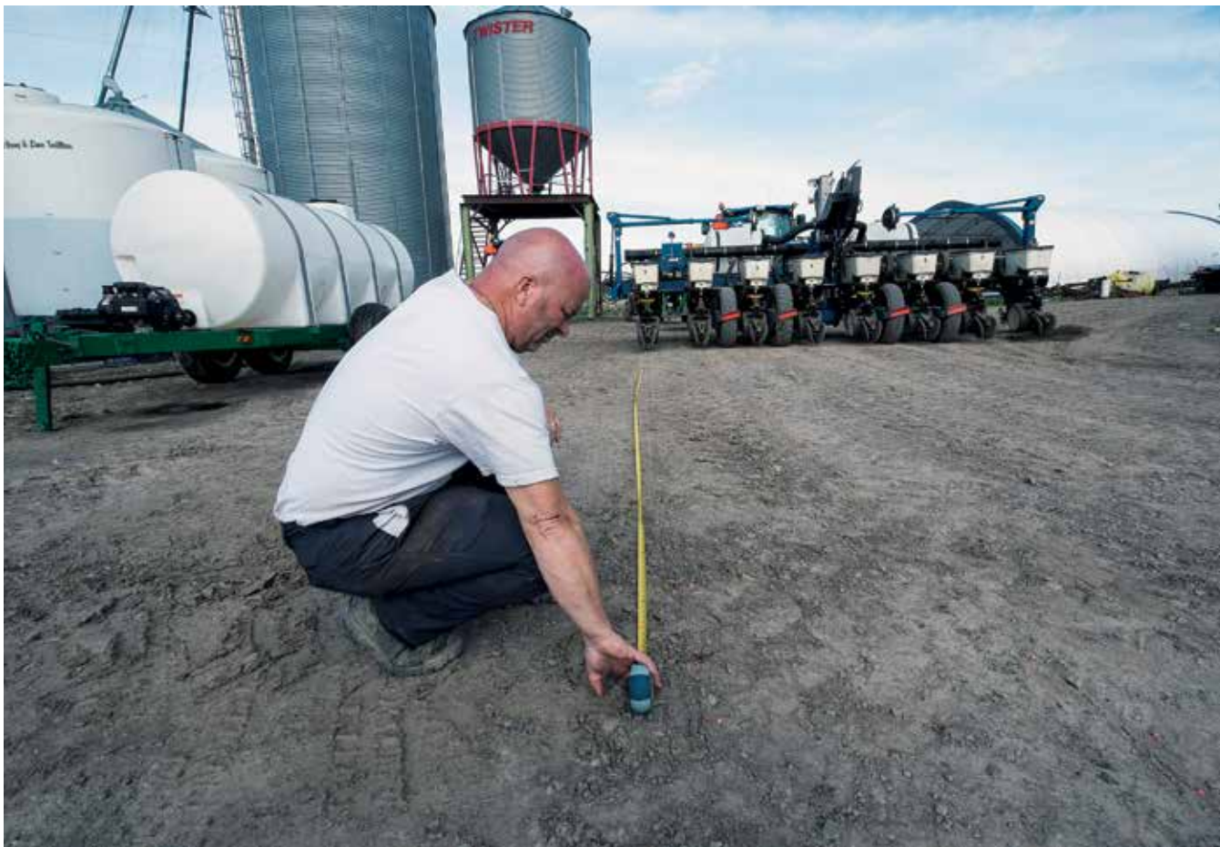
Daniel Guay calibre son semoir dans sa cour en mesurant l'espace entre les grains de maïs laissés au sol. Une opération qu'il juge essentielle avant de rentrer dans les champs.
