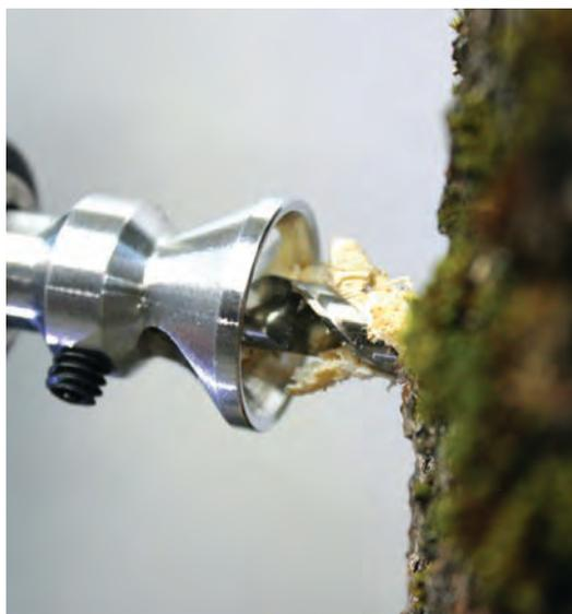
Ce butoir porte-mèche d'Ateliers Pruno évacue les copeaux de manière continue pendant le perçage afin d'éviter le bourrage dans les cannelures de la mèche.
