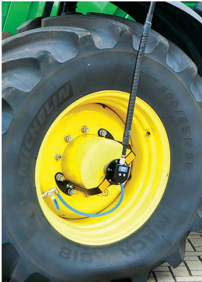
Conduites passant par le garde-boue sur un joint tournant extérieur (Source PTG.info).
