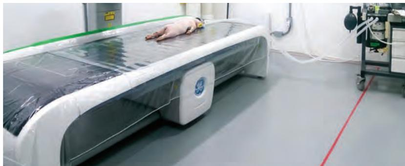
Dans cette salle d'attente, les porcs sont endormis avant d'être envoyés à l'ostéodensitomètre. Cet appareil permet d'évaluer la composition des porcs vivants, comme le muscle, le gras et la composition osseuse. Cela permet de déterminer plus efficacement l'effet d'un traitement minéral sur la composition et la densité minérale osseuse.
