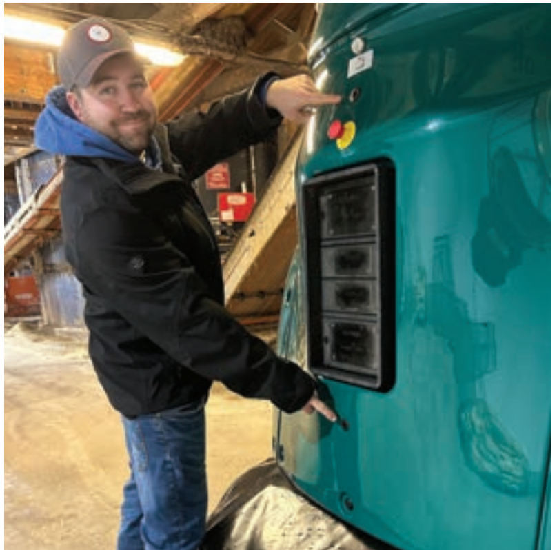
Devyn McFadden montre deux des nombreux capteurs de sécurité placés tout le tour du robot. Ils servent à détecter les obstacles autour: objets, personnes ou animaux. Il les nettoie régulièrement pour s'assurer du bon fonctionnement. Le pare-chocs noir sert aussi pour la sécurité.
