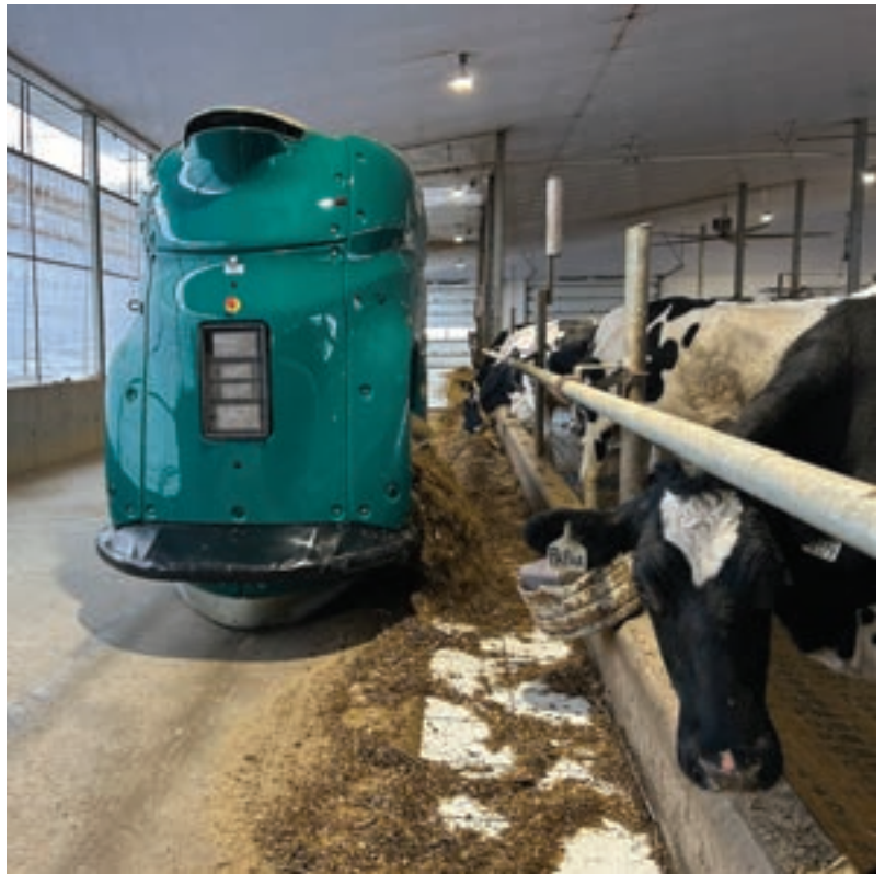
La navigation du robot est assurée par deux lasers, en haut à l'avant et à l'arrière. Ils captent les réflecteurs. C'est ce que l'on voit à la droite du robot sur un poteau. Il doit en voir au moins deux pour se déplacer.
